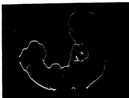
Fig.4 : "marqueurs" résultant de l'algorithme de r,h maxima (en gris) et concavités (en blanc)
