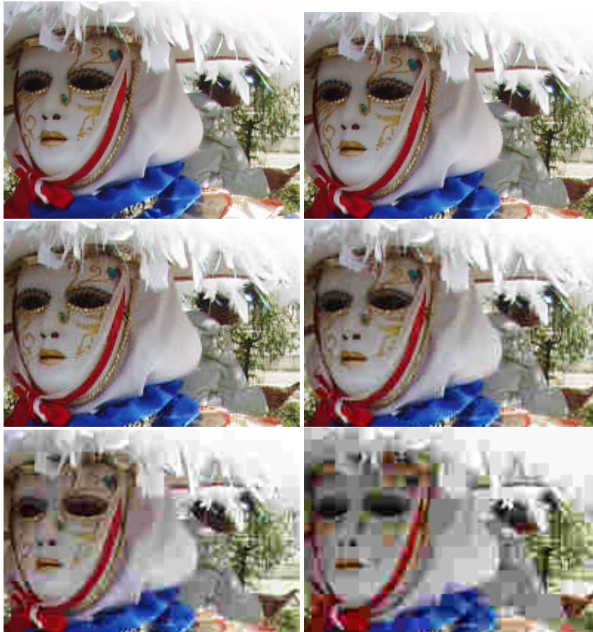
Figure 1.5 – Agrandissement d'une zone d'image codée par JPEG. L'image en haut à gauche est l'originale non codée. Les facteurs de compression (pour l'image entière) valent ensuite 5,4 (en haut à droite), 12,1 et 20 (ligne du centre), 30 et 40 (ligne du bas)
